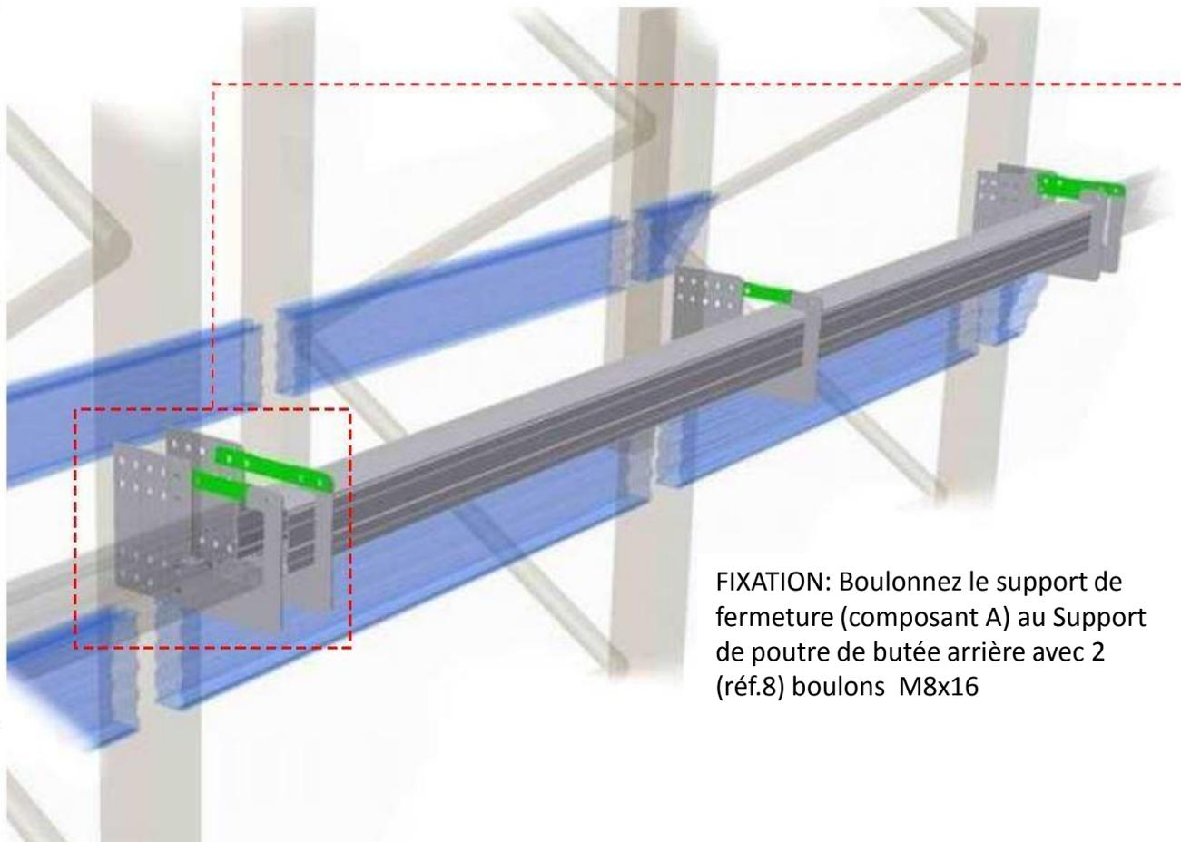
FIXATION: Boulonnez le support de fermeture (composant A) au Support de poutre de butée arrière avec 2 (réf.8) boulons M8x16
