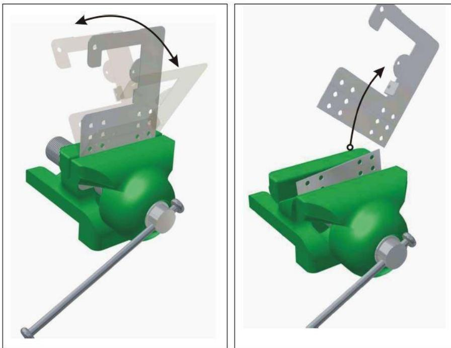
Note 1: Les lignes de coupe sont placées à différents intervalles déterminant ainsi la distance de la lisse stop palette par rapport au montant d'échelle.
