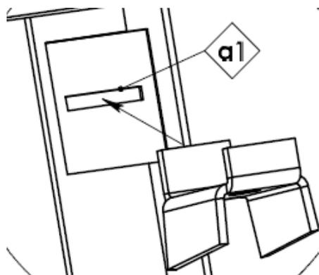
**Etape 3 :** De la même manière, insérer un 2<sup>ème</sup> crochet vers le bas de la cloison pour compléter la fixation de la cloison.
