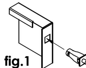
**Etape 2 :** Insérer la cloison dans l'armoire.
