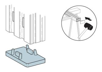
2 Mise en place des crochets (4 crochets par tablettes)
