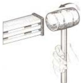
*Si le montage du pied est difficile. Il est possible de lever la traverse du bas avec un maillet et de serrer avec une pince les montants pour mettre les pieds. Ensuite, redescendre la traverse.*
