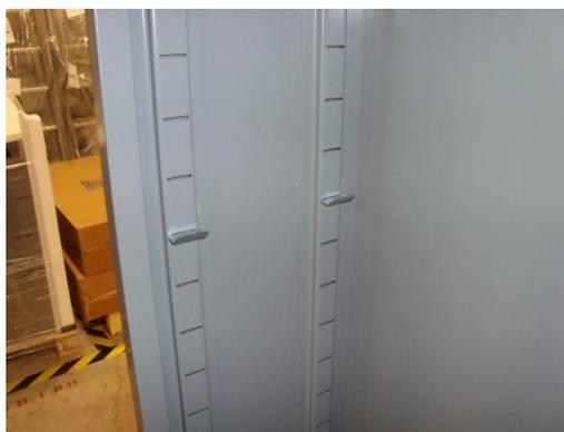
Mettre les crochets dans les perforations sur les côtés. Il faut mettre 4 crochets par tablette.
